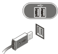
Рисунок 6. Подключение к разъемам USB
